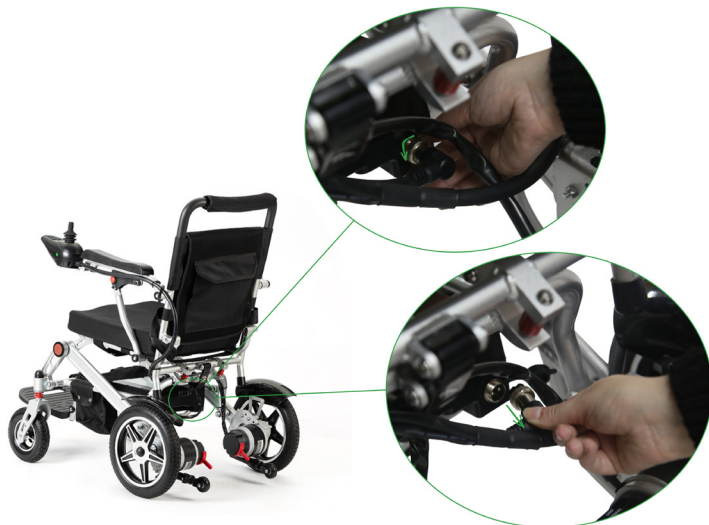
Imagem 9 - Remoção do cabo de energização interna
