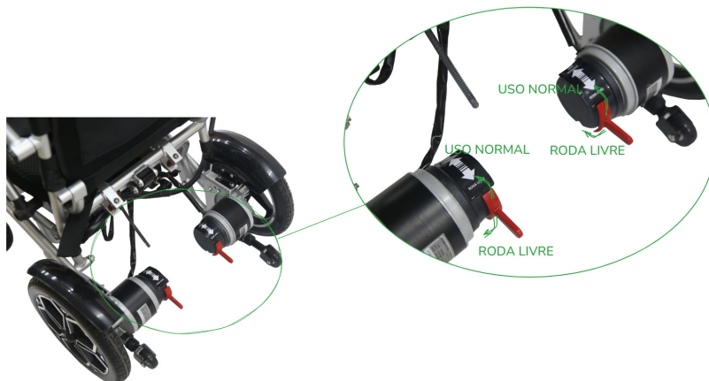
Imagem 12 - Mecanismo de roda livre / uso normal para funcionamento do freio eletromagnético de estacionamento
