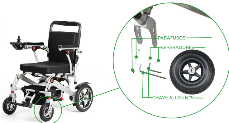
Imagem 18 - Processo de substituição das rodas dianteiras
