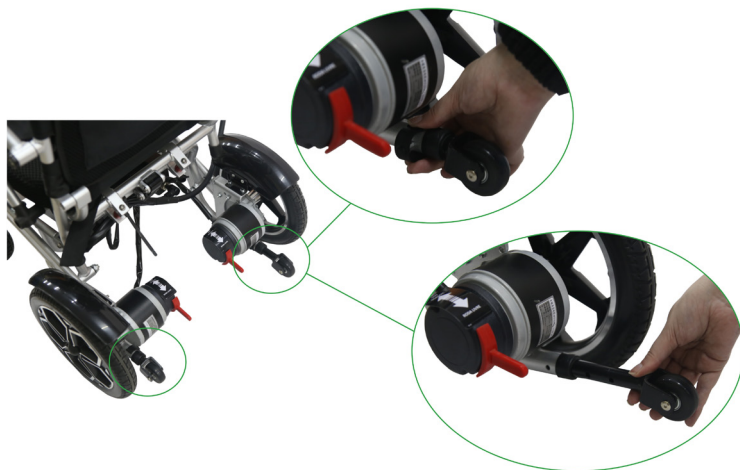
Imagem 8 - Regulagem e remoção das rodas de apoio
