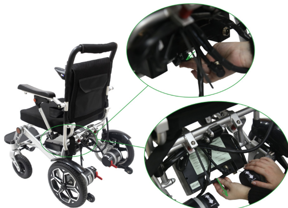
Imagem 10 - Remoção do contêiner de baterias
