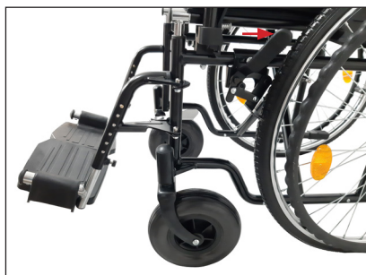
a) Freio manual de estacionamento desativado.
