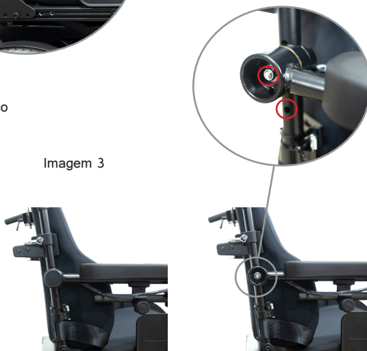
a) Mecanismo de ajuste de altura do braço nos modelos Freedom Millennium R/RT
