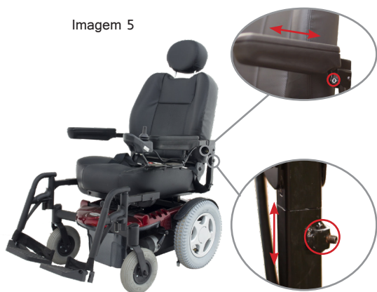
a) Mecanismo de regulagem de altura dos apoios de braços na Freedom Millennium C
