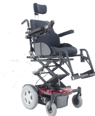
b) Freedom Millenium R com elevação (lift) do banco
