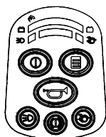
a) Indicador luminoso mostrando o nível 1 de Speed (Atenuador de velocidade)
