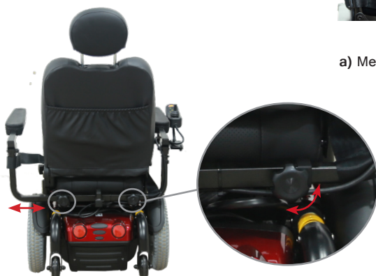
a) Mecanismo de ajuste de largura dos apoios de braços na Freedom Millennium C
