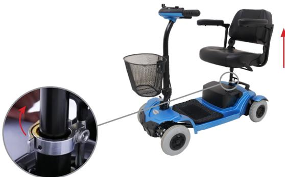
a) Mecanismo de remoção do módulo traseiro
