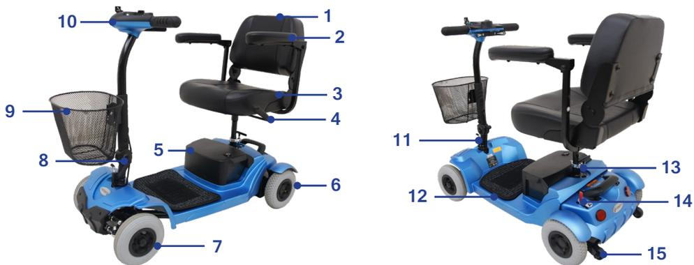
Imagem 1 - Componentes da Cadeira de Rodas Scooter Motorizada Freedom Mirage S
