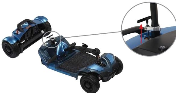
a) Mecanismo de remoção do módulo traseiro
