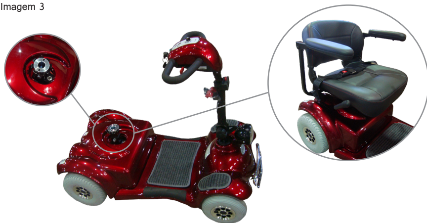
a) Mecanismo de remoção do banco
