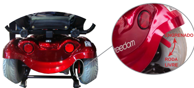
a) Alavanca de acionamento do modo roda livre
