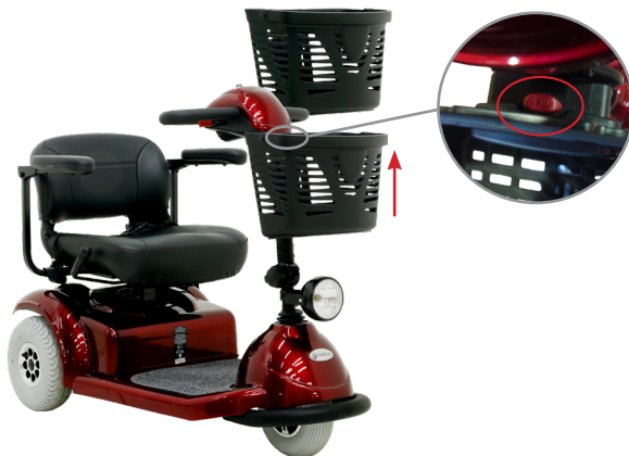
a) Mecanismo de remoção do cesto dianteiro
