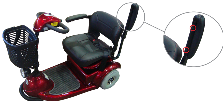
a) Mecanismo de fixação das almofadas dos apoios de braços
