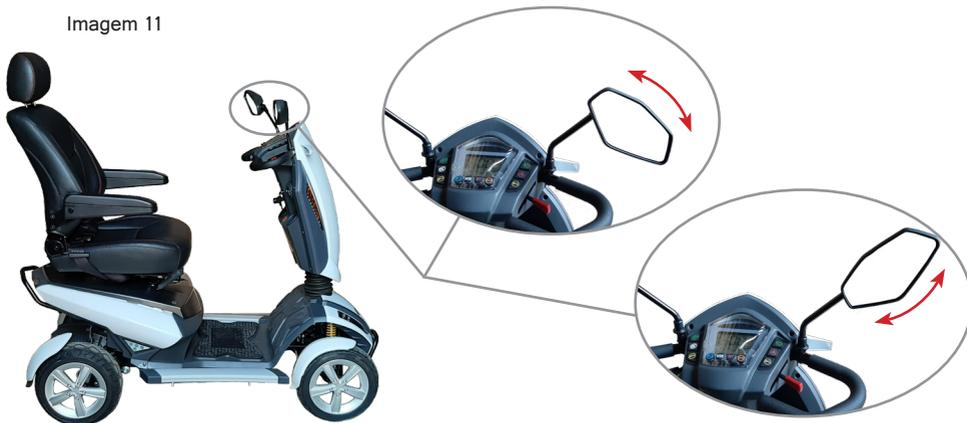
a) Ajuste de inclinação dos espelhos retrovisores
