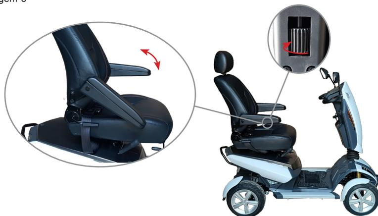
a) Ajuste de inclinação dos apoios de braços
