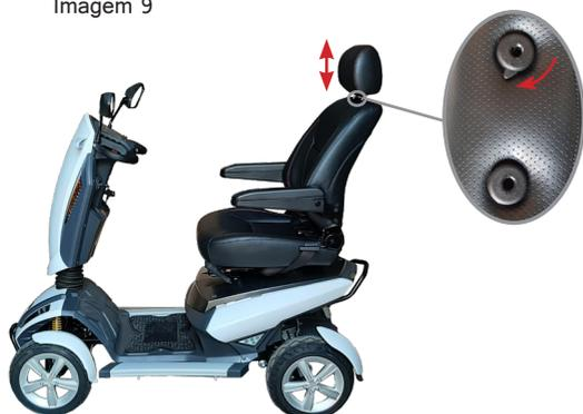
O apoio de cabeça é removível e possui ajuste de altura. Pressione a trava do suporte, localizada na parte superior do encosto, e deslize o apoio de cabeça até removê-lo ou para ajustá-lo na altura desejada.
