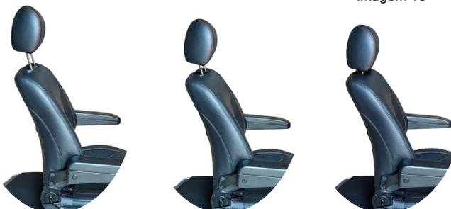
a) Níveis de regulagem de altura do apoio de cabeça
