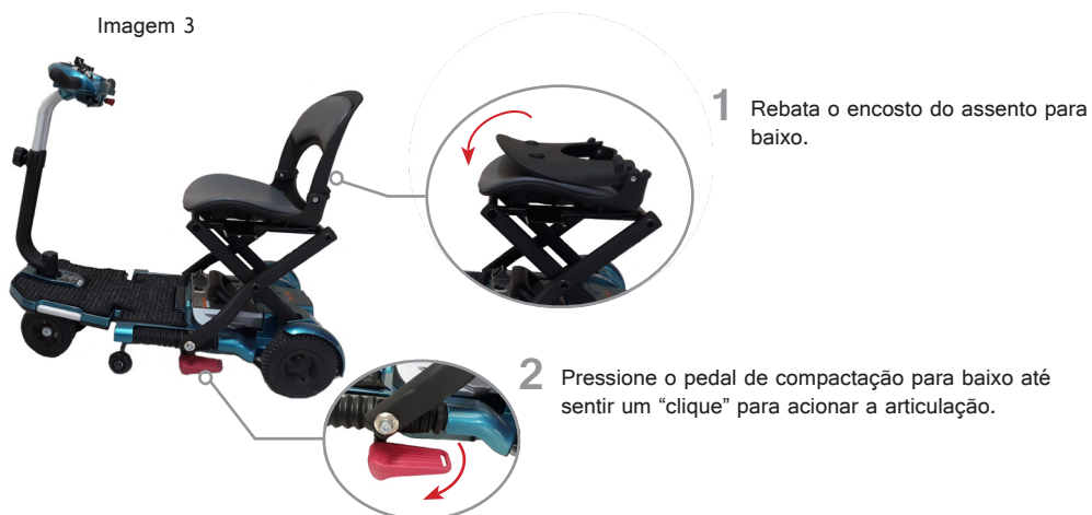
a) Passos 1 e 2 para compactação da Freedom Mirage LP
