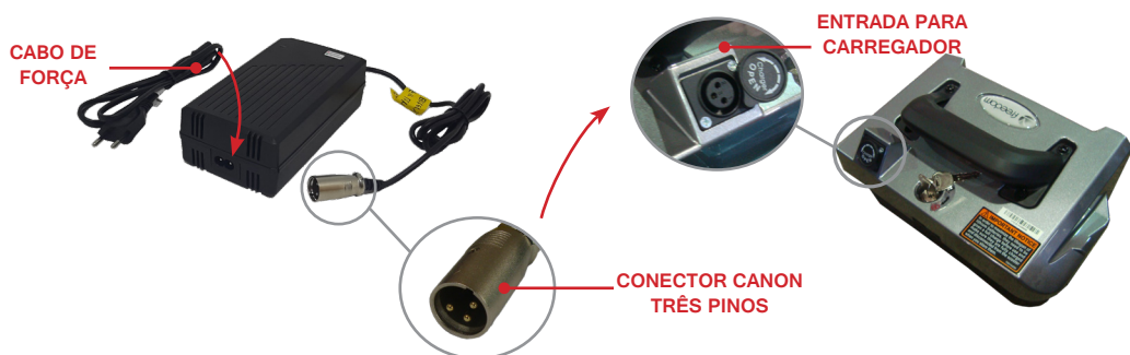
a) Esquema de conexões para recarga da bateria
